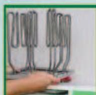
Odbezpiecz pokrywę zbiornika i wyjmij grzałki a następnie postaw je odwrócone na obudowie (nie ma potrzeby rozłączania przewodów!).
