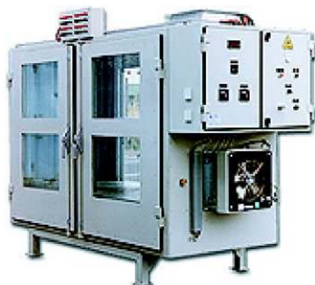
- Banc d'essais de ventilateur pour climatiseur automobile - Automotive air conditioner test bench - Stanowiska pomiarowy dla przemysłu motoryzacyjnego [klimatyzator]
